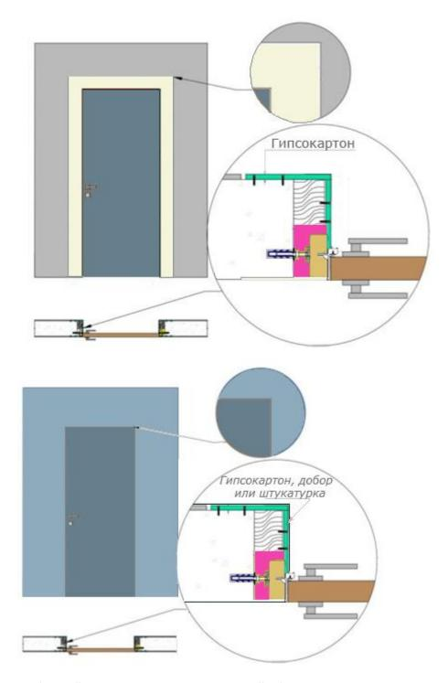
С обратной стороны для фиксации деталей обрамляющих проём можно закрепить брус компенсирующий расстояние. Затем с использованием ГКЛ обшить заднюю часть проёма.
