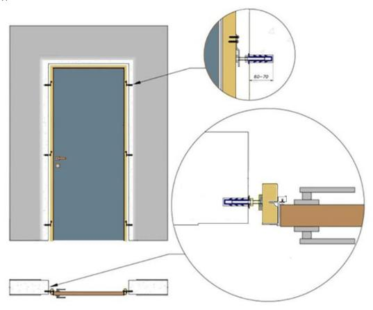
Стоевые фиксируем в проеме и навешиваем полотно, регулируем в плоскостях при помощи скрытых петель. Выставляем зазоры между полотном и коробом, пеним
